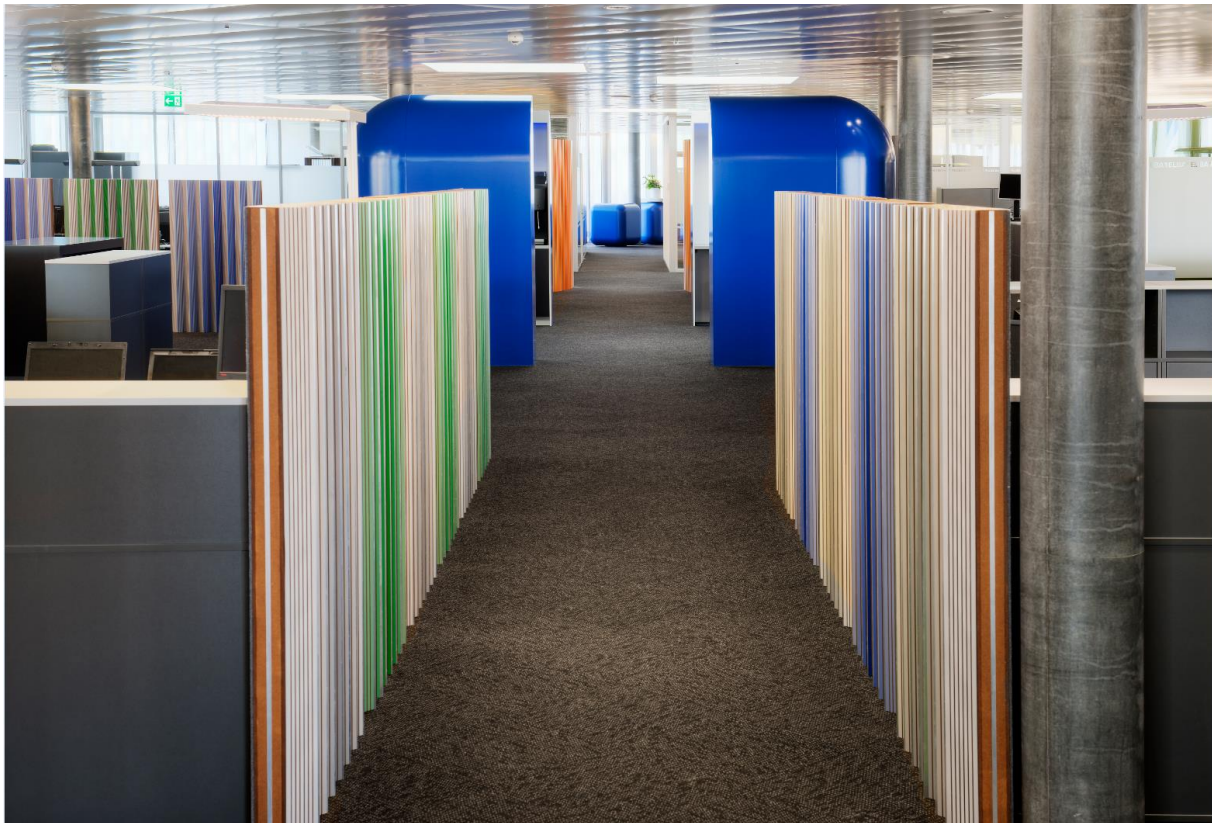
Abbildung 31: Erschliessung und Privatheitsregulation: Abschirmung durch halbhohle Akustik-Installation zwischen Arbeitsplätzen und Verkehrswegen (Einflussfaktor B4, B10, B14, B17, B18)
